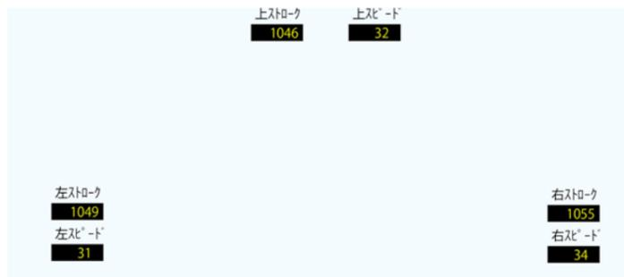
上左右の 3 箇所の掘進中のストローク計データ
