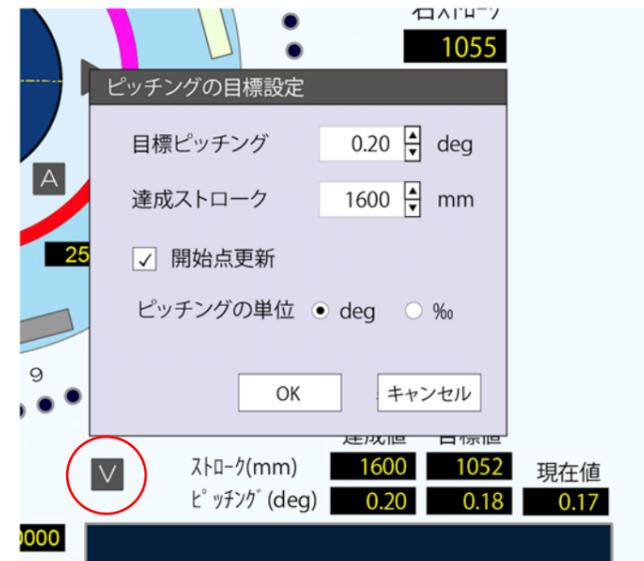
「V」ボタンを押すとピッチングの目標設定画面が表示されます。目標ピッチングと達成ストロークを入力します。掘進中等で開始値が変わった場合には、開始点更新にチェックを入れると開始値が現在値に変更されます。入力完了したら OK ボタンを押します。
