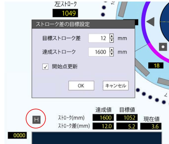
「H」ボタンを押すとストローク差の目標設定画面が表示されます。目標ストローク差と達成ストロークを入力します。掘進中等で開始値が変わった場合には、開始点更新にチェックを入れると開始値が現在値に変更されます。入力完了したら OK ボタンを押します。 ※管理モードを方位角（ジャイロ管理）にしている場合は目標ストローク差が目標方位角に変わります。
